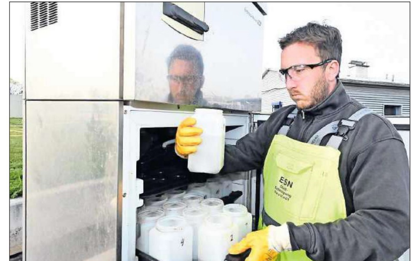
Als Pilotprojekt schon in Neustadt getestet: Abwasser-Proben sollen zeigen, wie verbreitet das Corona-Virus gerade ist. Mit der Methode will sich das Gesundheitsministerium nun landesweit Überblick verschaffen. ARCHIVFOTO: MEHN
